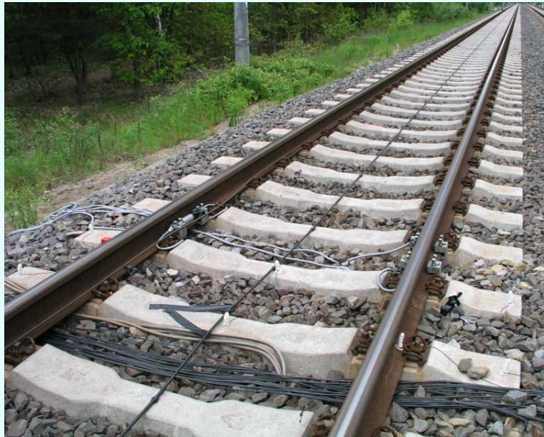
E14-Stützpunkt (Gleis Berlin - Hamburg), statische Stützpunktsteifigkeit k_{\text{stat},E14} = 27,5 \text{ kN/mm}
